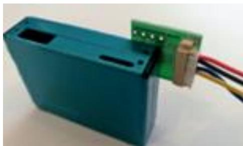
Slika 9. Priključivanje tiskane pločice sa strujnim krugovima na Plantowerov davač
